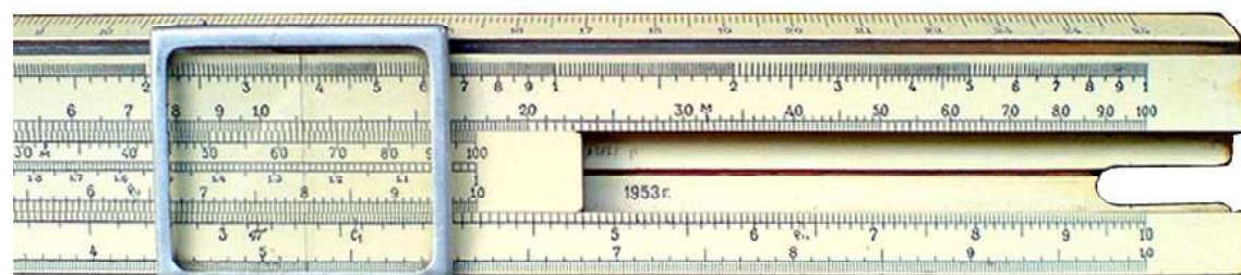
Рис. 10. Способ умножения со смещением движка влево
