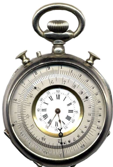
Рис. 22. Первая логарифмическая линейка, объединенная с часами (разработка Meurat & Perdrizet 1890-х годов)
