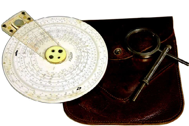
Рис. 17. Круговая логарифмическая линейка Rotarule Modell AA 1939 г. для работы в полевых условиях, с чехлом и линзой в комплекте
